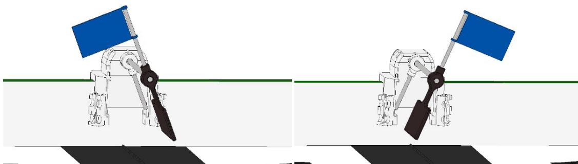
Figura 5 – Sistema das Bandeiras. O lado para o qual a bandeira está virada é o robô que tem a bandeira conquistada.
